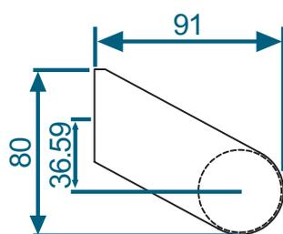
**SUPPORT INCLINÉ 91 mm***INTÉRIEUR / EXTÉRIEUR Ø 42,4 X EP. 2 MM*
