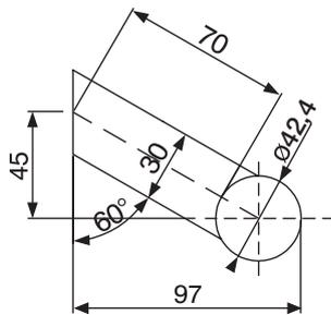
**SUPPORT INCLINÉ 70 mm***INTÉRIEUR / EXTÉRIEUR Ø 42,4 X EP. 2 MM*
