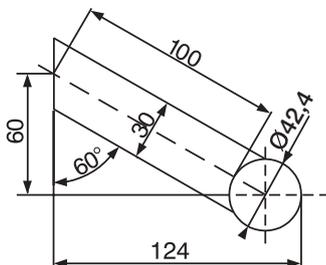
**SUPPORT INCLINÉ 100 mm***INTÉRIEUR / EXTÉRIEUR Ø 42,4 X EP. 2 MM*
