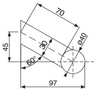
**SUPPORT INCLINÉ 70 mm***INTÉRIEUR / EXTÉRIEUR  $\varnothing 40$  MM*
