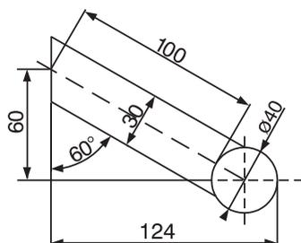
**SUPPORT INCLINÉ 100 mm***INTÉRIEUR / EXTÉRIEUR  $\varnothing 40$  MM*
