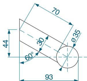
**SUPPORT INCLINÉ 70 mm***INTÉRIEUR / EXTÉRIEUR  $\varnothing 35$  MM*
