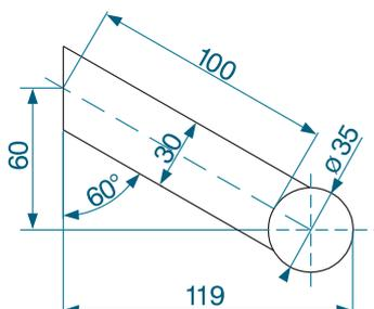
**SUPPORT INCLINÉ 100 mm***INTÉRIEUR / EXTÉRIEUR  $\varnothing 35$  MM*
